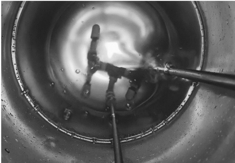
Abbildung 7.4: Innenansicht des Druckbehälters inklusive zwei Edelstahlflanzen zum Wasser- austritt (rechts) und CO 2 -Begasung mit Konstruktion zur feinen Gasverteilung (unten)
