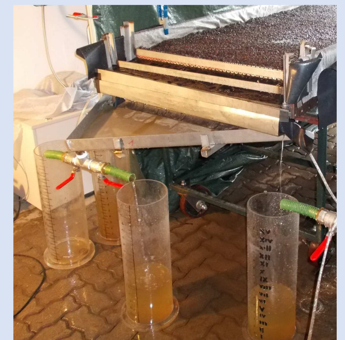
Abb. 3: Physikalisches Laborversuchsmodell mit separierter Abflusserfassung
