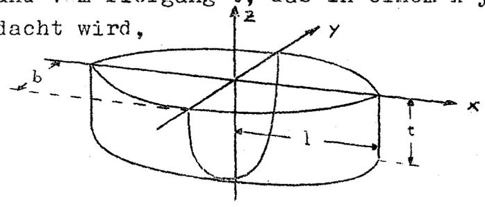
zunächst über zu neuen Koordinaten  $\xi, \eta, \zeta$ , in welchen das Schiff die halbe Länge  $l$ , den Tiefgang  $k = t/l = 2t/L$  und die Breite  $b/l$  hat. Alsdann ersetzt man das Schiff durch einen Umströmungskörper, der bei der Ueberlagerung einer homogenen Strömung in  $\xi$ -Richtung und einer von einer Quell-Senken-Verteilung der Intensität  $m(\xi, \zeta)$  über das in der Mittschiffsebene liegende Rechteck
