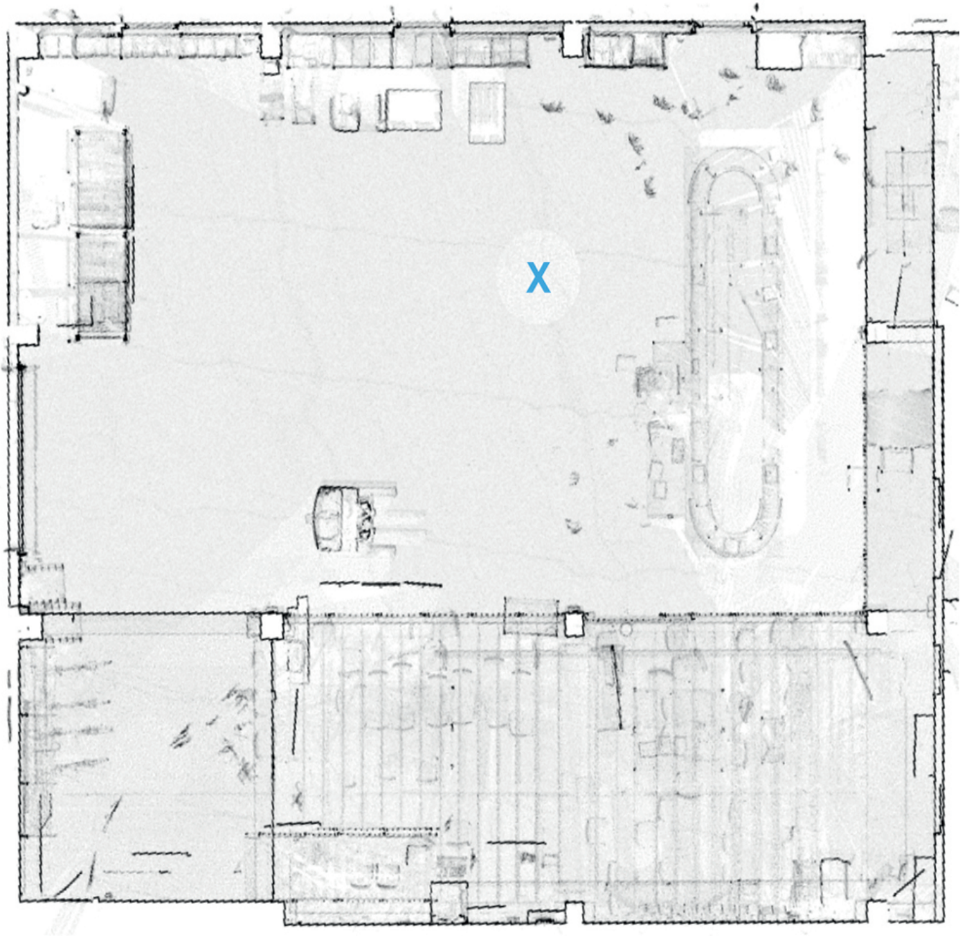
Abbildung 1: Grundriss der Versuchshalle mit Position der 3D-Laserscanner, Bild: Johannes Hinckeldeyn, Marko Thiel
