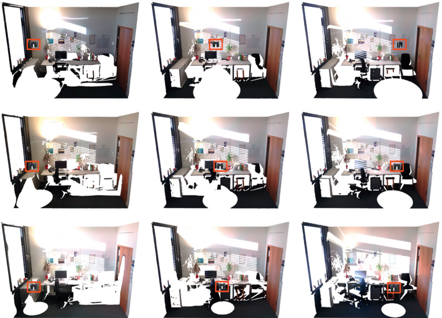
Abbildung 5: Punktwolke der Messung auf Abschattungen und Verdeckungen, Bild: Johannes Hinckeldeyn, Marko Thiel
