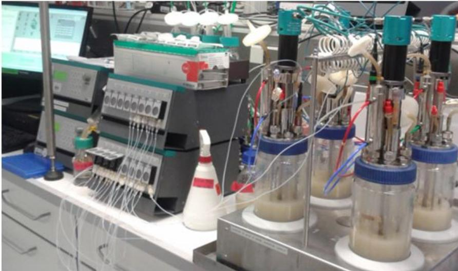
**Abb. 9:** Fermentation im Dasgip-Bioreaktor.
