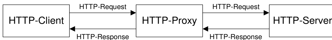
Abbildung 132: HTTP-Proxy zwischen HTTP-Client und HTTP-Server
