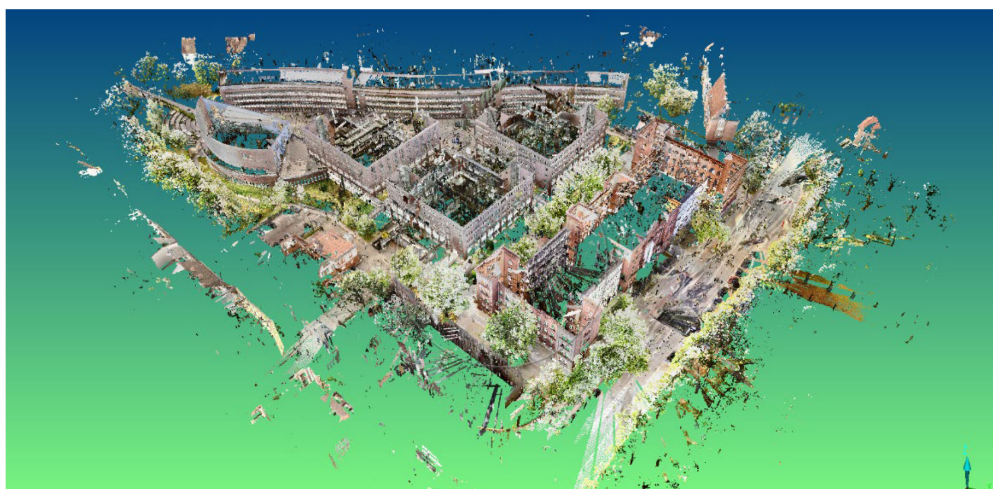
Abbildung 6.4: Ansicht des nördlichen Teils der gesamten Punktwolke in der Software Faro Scene
