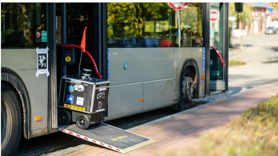
Abbildung 2.24: Automatisierte Ausfahrt des Transportroboters aus dem Bus
