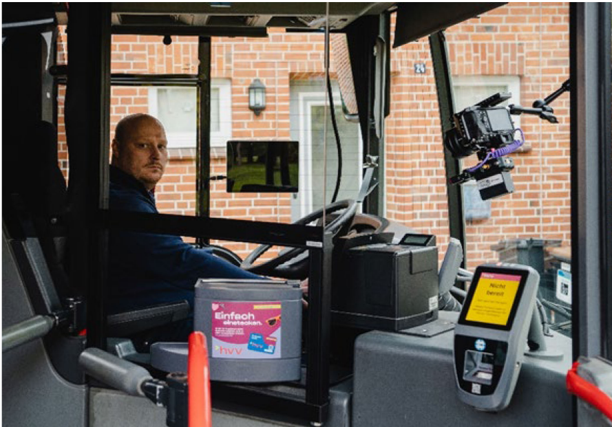
Abbildung 2.29: Tablet und GPS-Gerät sind in der Fahrer*innenkabine beispielhaft während des Testbetriebs angebracht (Hr. Scheske, vhh.mobility)
