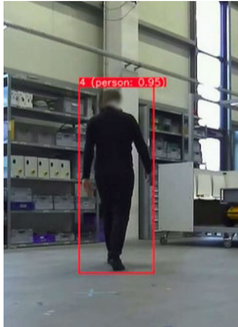
Abbildung 2.38: Objekt-Tracking einer laufenden Person im Innenraum (mit zeitweiser Verdeckung der Person)
