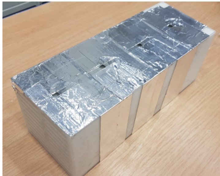
Abbildung 5.16: Aufbau der Variante I des Probenkörpers für das PCM-Kühlelement (a); Darstellung von vier konsekutiv angeordneten Probenkörpern der Variante I mit einer Gesamtlänge von 280 mm. Durch die Löcher im Aluminiumklebeband können Widerstandsthermometer zur direkten Messung der PCM Temperatur eingesetzt werden. (b)
