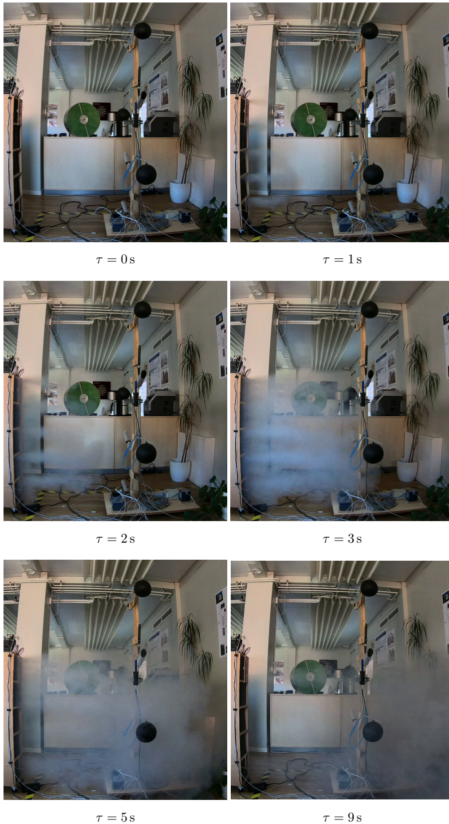
Abbildung 5.9: Visualisierung der lokalen Auswirkung des PCM-Turms im Leichtbau mittels Nebel
