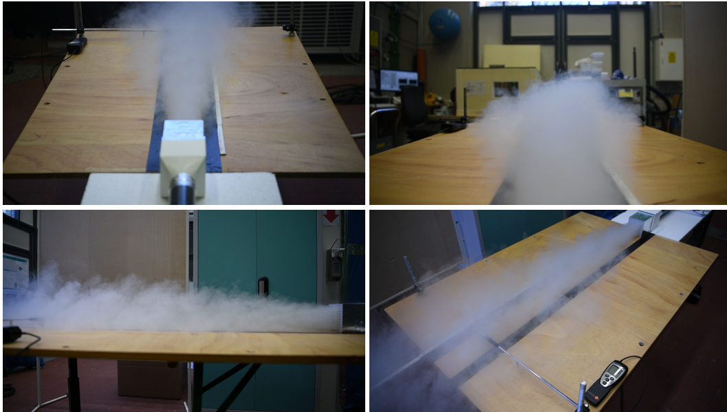
Abbildung 5.23: Visualisierung des Abströmbereichs des Probenkörpers Variante I mittels Nebel
