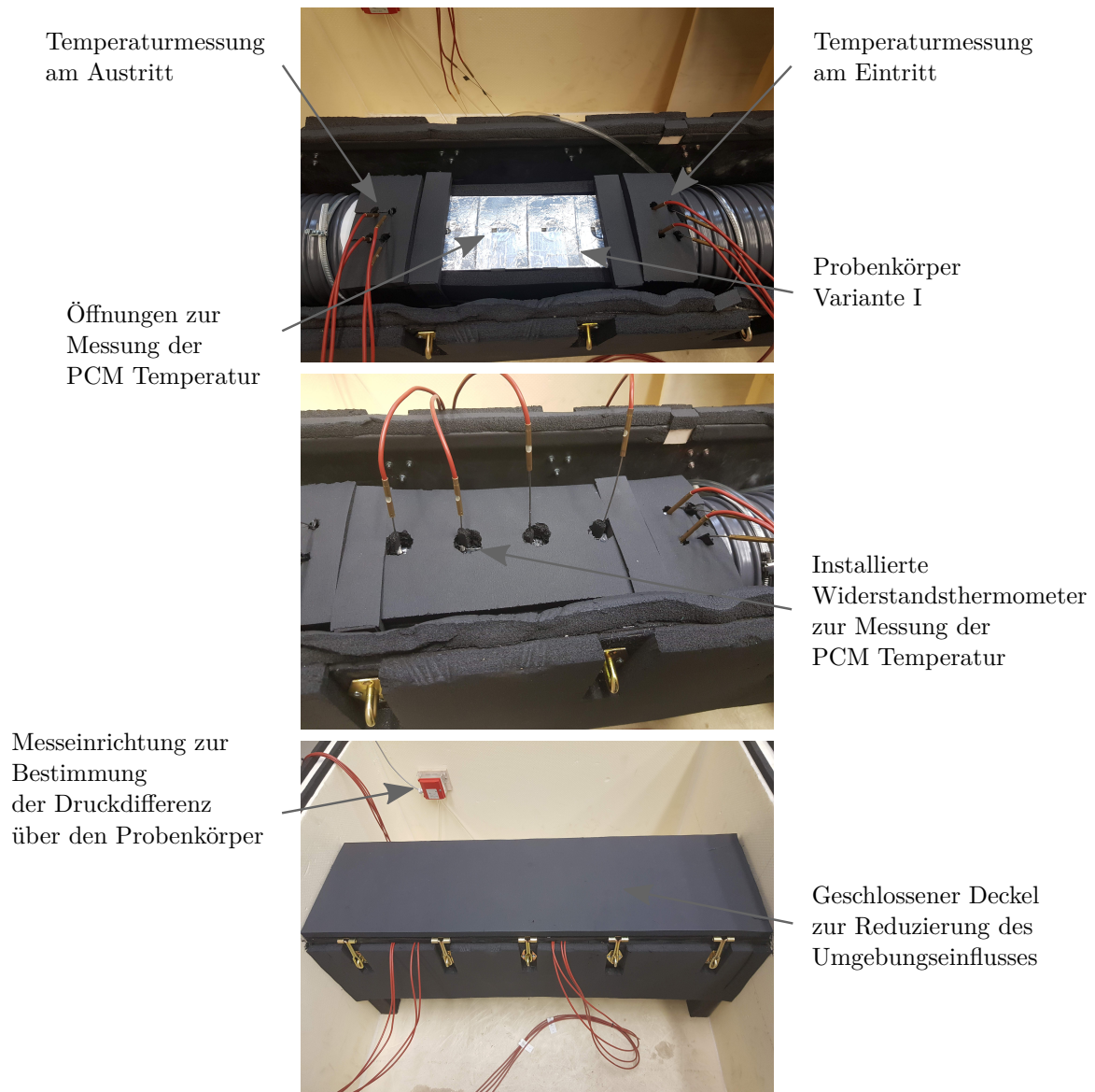
Abbildung 5.19: Probenkörper der Variante I im eingebauten Zustand im Versuchsstand
