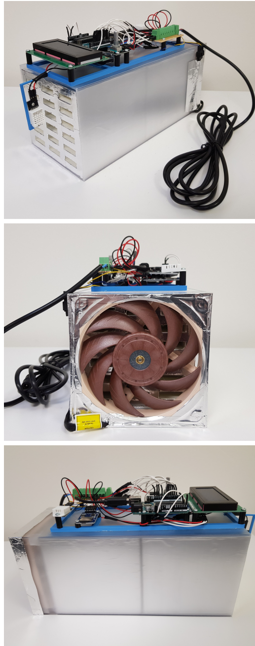
Abbildung 7.1: Aufbau der Halterung des Kühlelements
