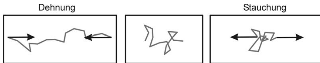
Bild 36: Entropie-Elastizität eines Polymerknäuels nach [SRT98a]
