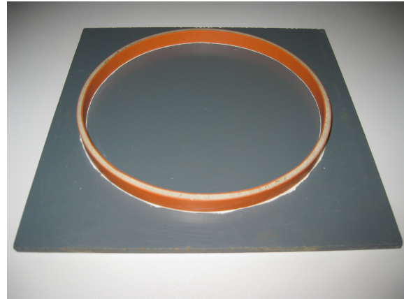
Abbildung 4.1: Schalung für die Herstellung von Mörtelscheiben für die Osmometer-Versuche.
