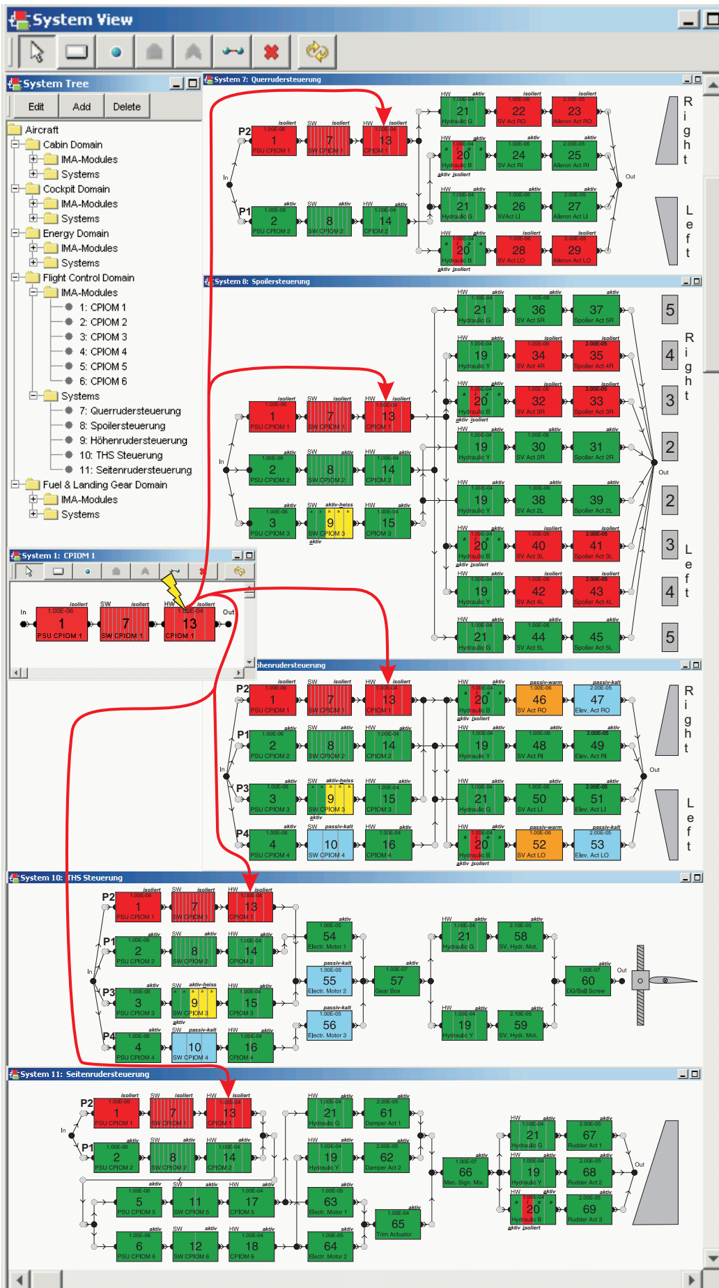
BILD 7: Rekonfigurierte primäre Flugsteuerungssysteme nach Ausfall von CPIOM 1
