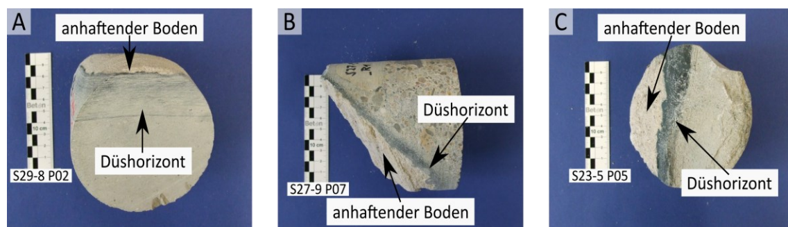
Abbildung 7.4: Erscheinungsform des Düshorizontes in untersuchten Düsenstrahlelementen: A) ausgedehnte dünne Schichtungen und begrenzter Bereich am angrenzenden Boden, B) örtlich begrenzt, Übergang zu Matrix mit Mörtelcharakter, C) im Randbereich begrenzter, stark konzentrierter Düshorizont
