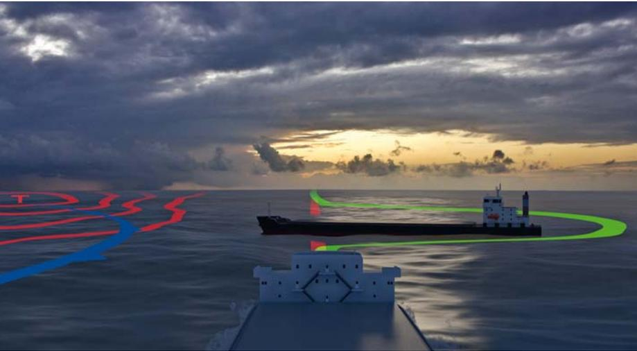
Das an Bord eines führerlosen Schiffes (Bildmitte) installierte so genannte Weather-Routing-System hat eine Kaltfront (blaue Linie) und ein Tiefdruckgebiet (rote Linien) ermittelt. Elektronisch gesteuert, weicht das Schiff, nachdem es das Signal erhalten hat, sowohl der sich ankündigenden stürmischen See als auch dem von Steuerbord kommenden Tanker aus und folgt der neuen Route (grüne Linie). Foto: Fraunhofer CML
