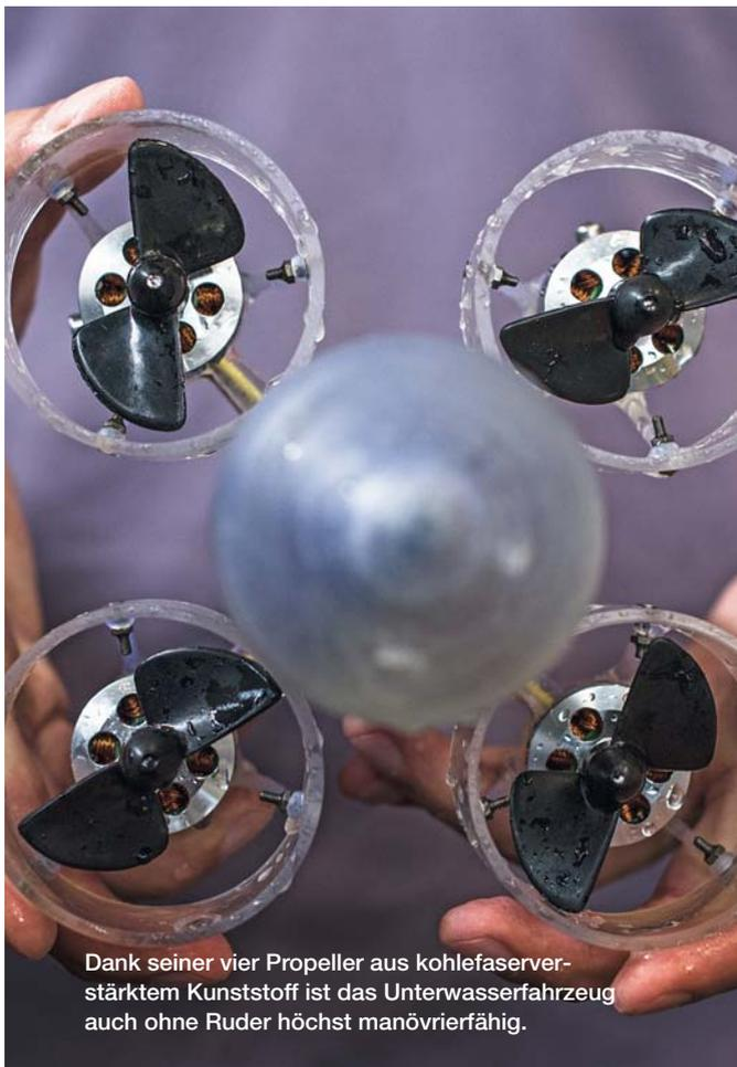
Dank seiner vier Propeller aus kohlefaserverstärktem Kunststoff ist das Unterwasserfahrzeug auch ohne Ruder höchst manövrierfähig.
