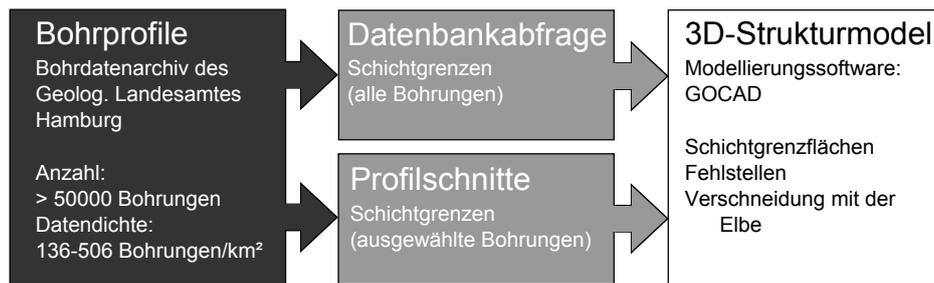
**Abbildung 4.6.:** Systematisches Vorgehen zur Erstellung eines geologischen Strukturmodells des oberflächennahen Untergrunds im Untersuchungsgebiet.
