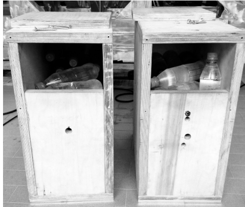
Bild 5: Mit Wasserflaschen befüllte hölzerne Dummies als Ersatz für Öfen
