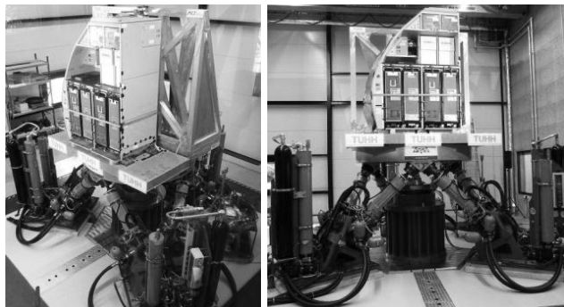
Bild 1: Hexapod-Prüfanlage mit vollbestückter Flugzeugbordküche
