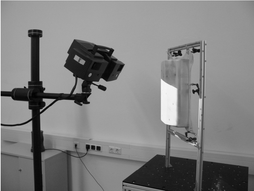
Bild 2: Scanprozess einer tiefgezogenen Doppelwanne
