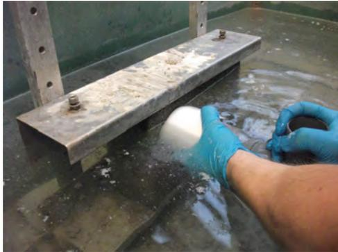
(c) Die Form und Stempel werden an der Betonfläche unter Wasser angesetzt
