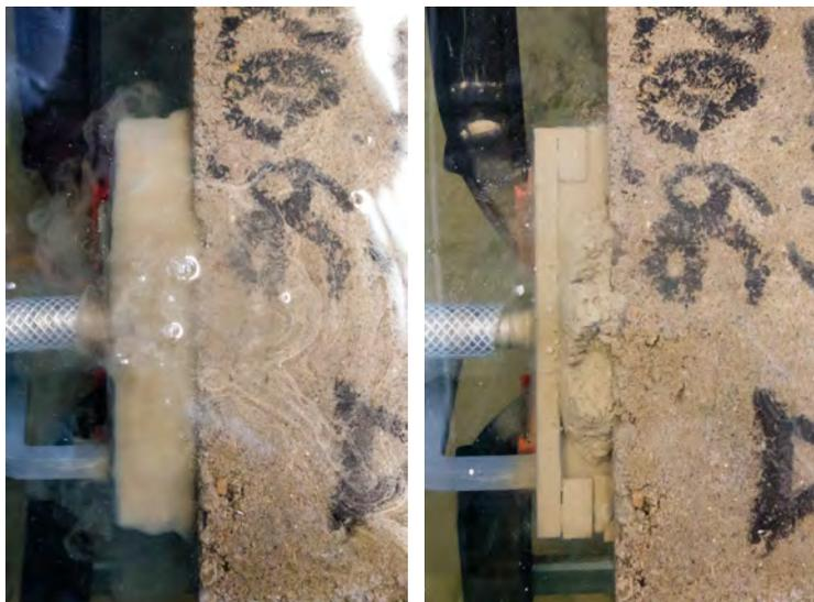
(c) beim Verpressen des Mörtels in (d) nach Verpressen des Mörtels in
