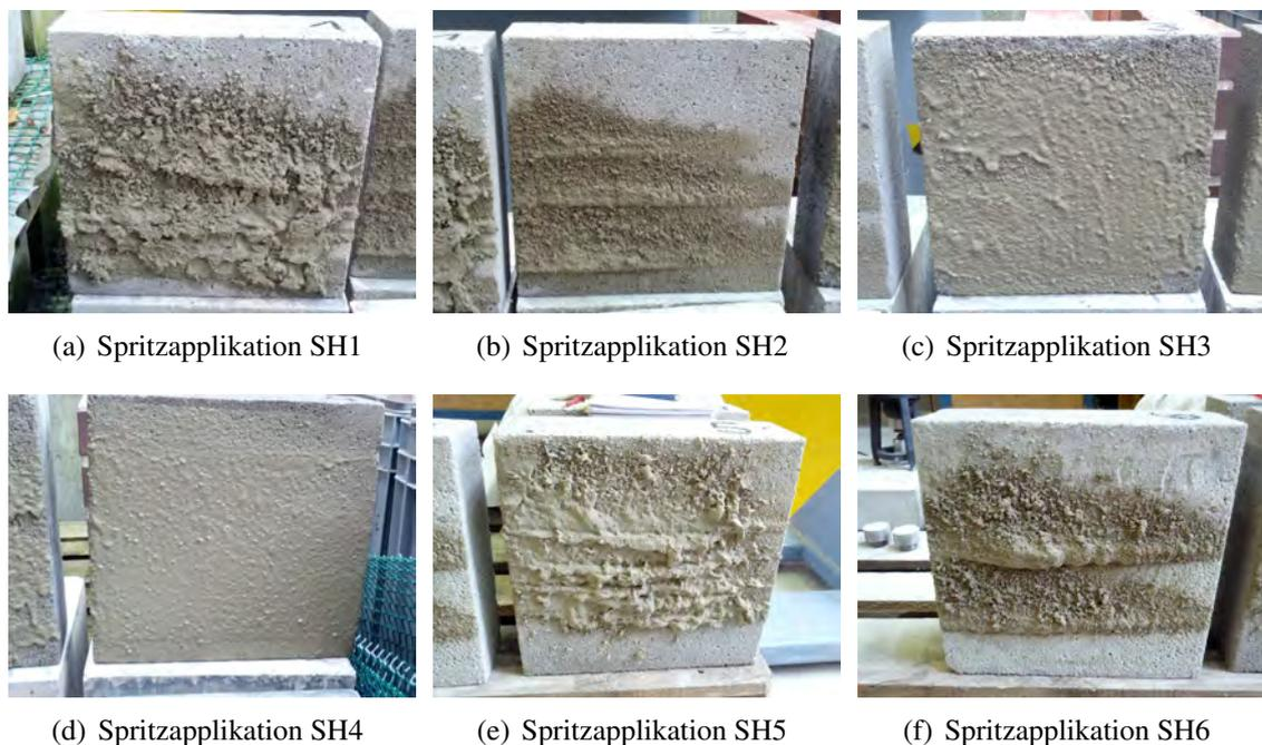
Abbildung F.1.: Applikationen SH 1 bis 6 mit Spritzapparatur an Luft
