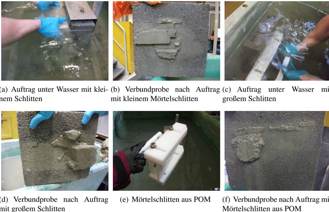
Abbildung 5.28.: Auftragsverfahren mit Mörtelschlitten
