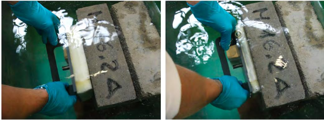
(a) Applikationsplatte an Betonoberfläche
