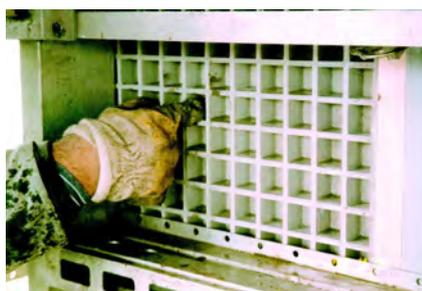
Abbildung 1.7.: Starre Schalung mit dahinterliegender Textilschalung aus [184]
