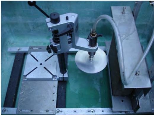
(a) Aufbau der Spritzapparatur
