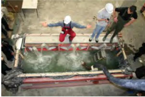
Abbildung 1.4.: Neues Verfahren für die Betoninstandsetzung unter Wasser im Großversuch aus [129]
