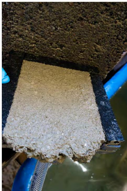
Abbildung 5.43.: Kein Verbund durch eingepressten Mörtel in Applikationsplatte mit festen Rändern
