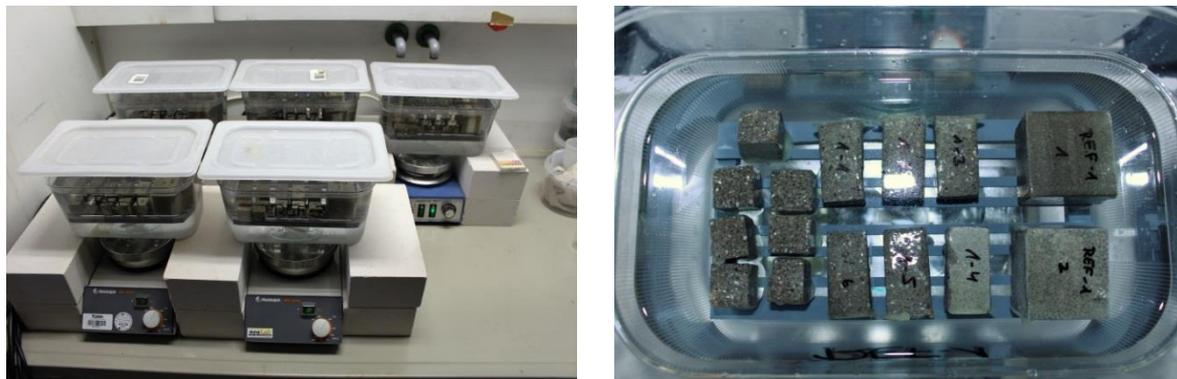
Abbildung 5-30: Versuche zur Änderung von Porenstruktur und Transportkoeffizienten (links: Versuchsbadern, rechts: Blick in ein Versuchsbad) [39]
