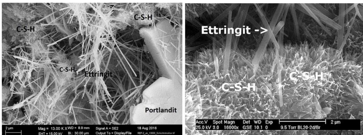
Abbildung 5-39: Detailaufnahmen von Zementsteinen (links: eigene REM-Aufnahme (13.000 x); rechts: ESEM-Aufnahme aus Stark und Wicht [127] (16.000 x))
