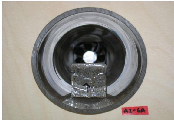
Abbildung 5-3: Trocknungsanlage (links: Gesamtanlage, rechts: einzelnes Trocknungsrohr mit Mörtelprisma)
