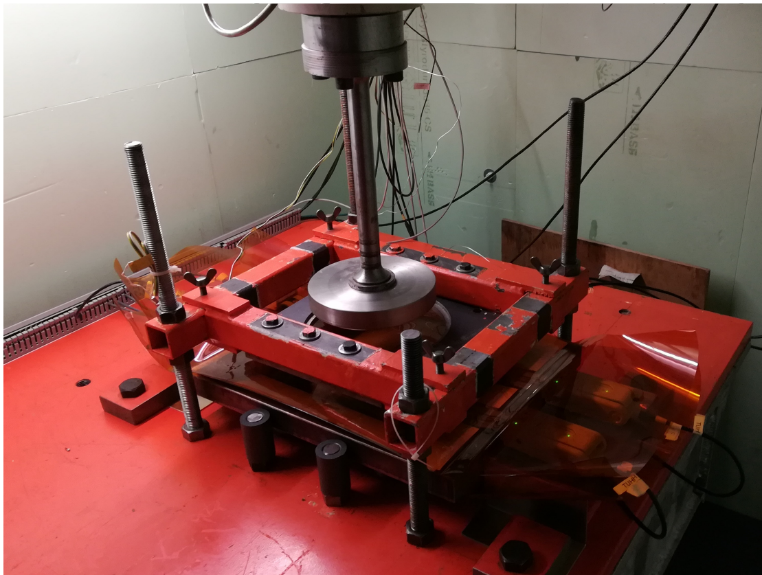
Abbildung 14: Versuchsaufbau im Kühlcontainer für die starre Struktur
