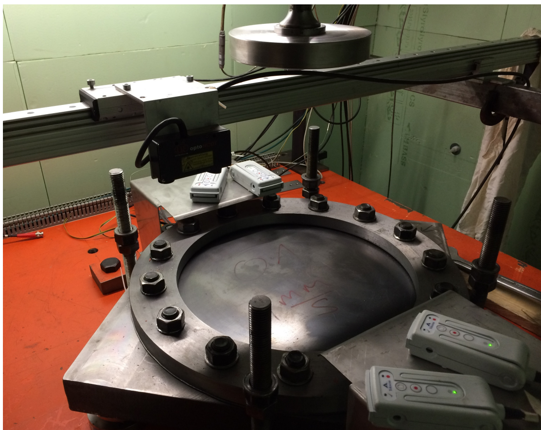
Abbildung 16: Versuchsaufbau im Kühlcontainer für die deformierbare Struktur
