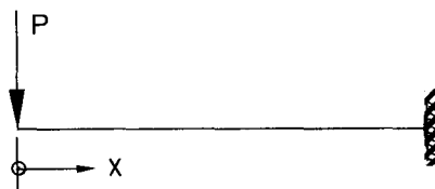
Bild 4.9: Kragträger mit Einzellast
