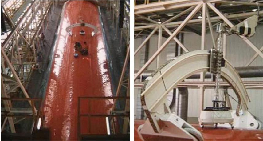
Abbildung 14: „Crown Inspection Mobile Platform“ CIMP [SGP98]
