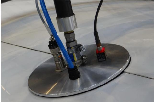
Abbildung 58: Optimierte Vakuumsaugfüße mit Abstands- und Drucksensoren auf einem überlappenden Blechstoß.
