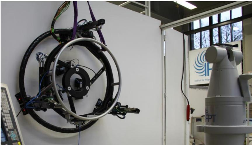
Abbildung 67: Messung der realen Geometrie des Roboters
