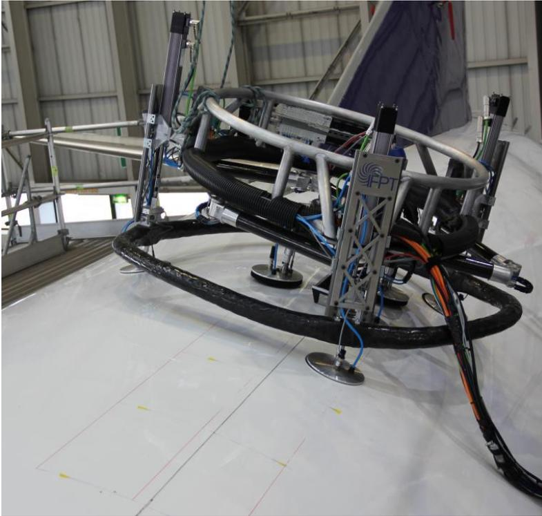
*Abbildung 71: Validierung des Gesamtsystems anhand einer automatisiert ausgeführten Flugzeuginspektion*
