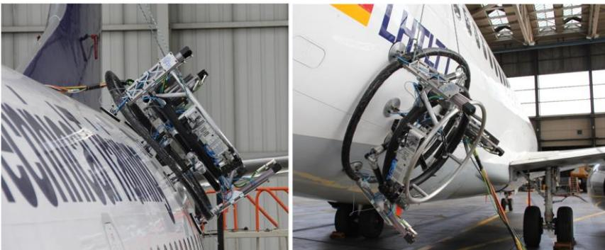
Abbildung 70: Bewegung des Roboters in vertikaler und überhängender Lage am Flugzeugrumpf
