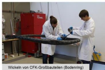
Abbildung 60: Herstellung von Teilkomponenten des Roboters
