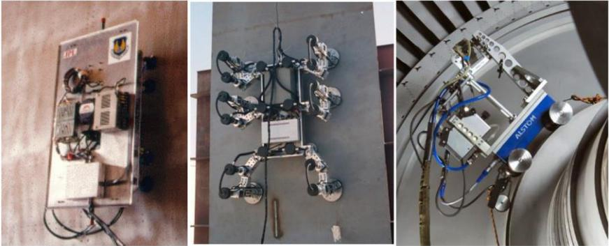
Abbildung 20: links: „Multifunction Automated Crawling System“ - MACS [BaBa00], mitte: REST [Gon13], rechts: „Mobile Robotic Scanner“ - MRS [Bog10]
