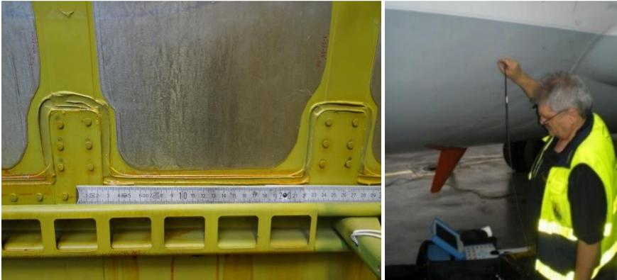
Abbildung 54: links: Aufbau einer "Chemical Milled Pocket", rechts: Heutiger Inspektionsprozess zur Rissprüfung mittels Wirbelstromsonde
