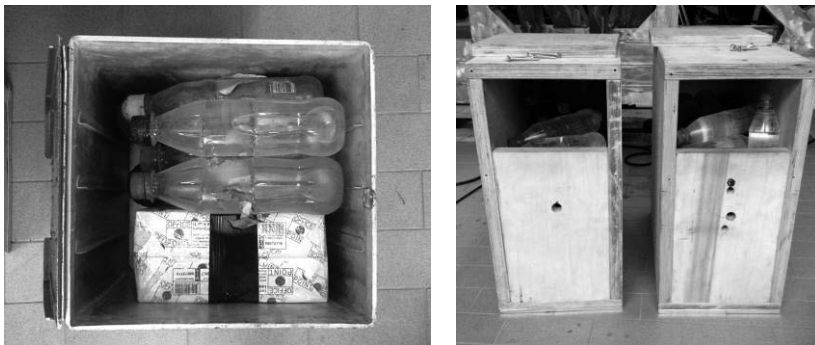
Bild 3: Beispiele von Dummylasten zur Beladung von Standardcontainern (links) und Ofen-Dummies (rechts)
