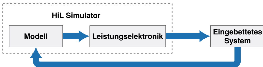
Abbildung 1: Konzeptskizze einer HiL Simulation
