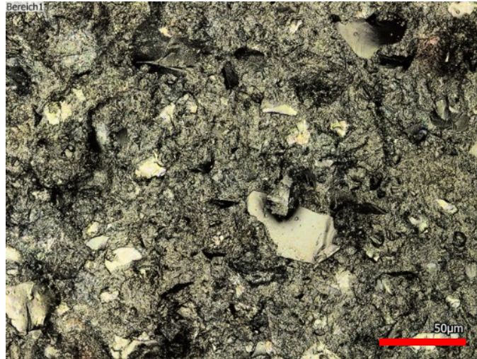
Abbildung 26. Exemplarische Darstellung einer Mörtelbruchfläche mittels Konfokalmikroskop.
