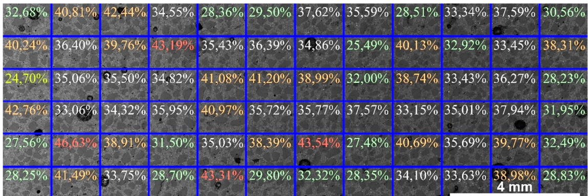
Abbildung 67. Analyse des Gesteinsanteils am verkleinerten R3-Raster (1,5 mm x 1 mm).
