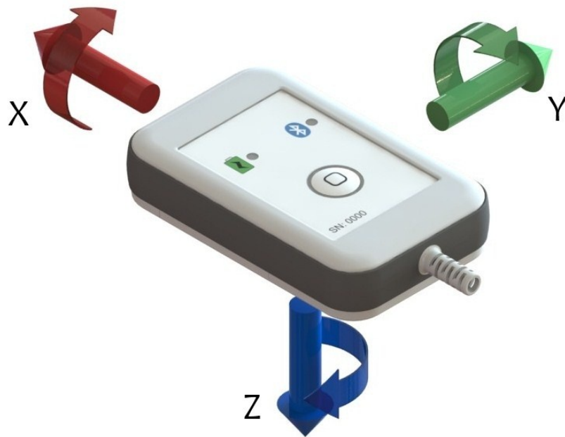
Abbildung 4.4: Achsen des Koordinatensystems der Inertialsensoren des Steuergeräts
