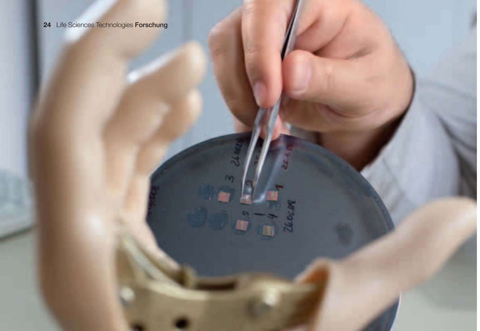
Je ein Mikrochip – im Bild auf einer Silicium-Scheibe – wird in die Armmuskulatur implantiert, wo dieser im Implantat die Signale zur Steuerung der Hand aufnimmt und an einen Mikrocontroller weitergibt.
