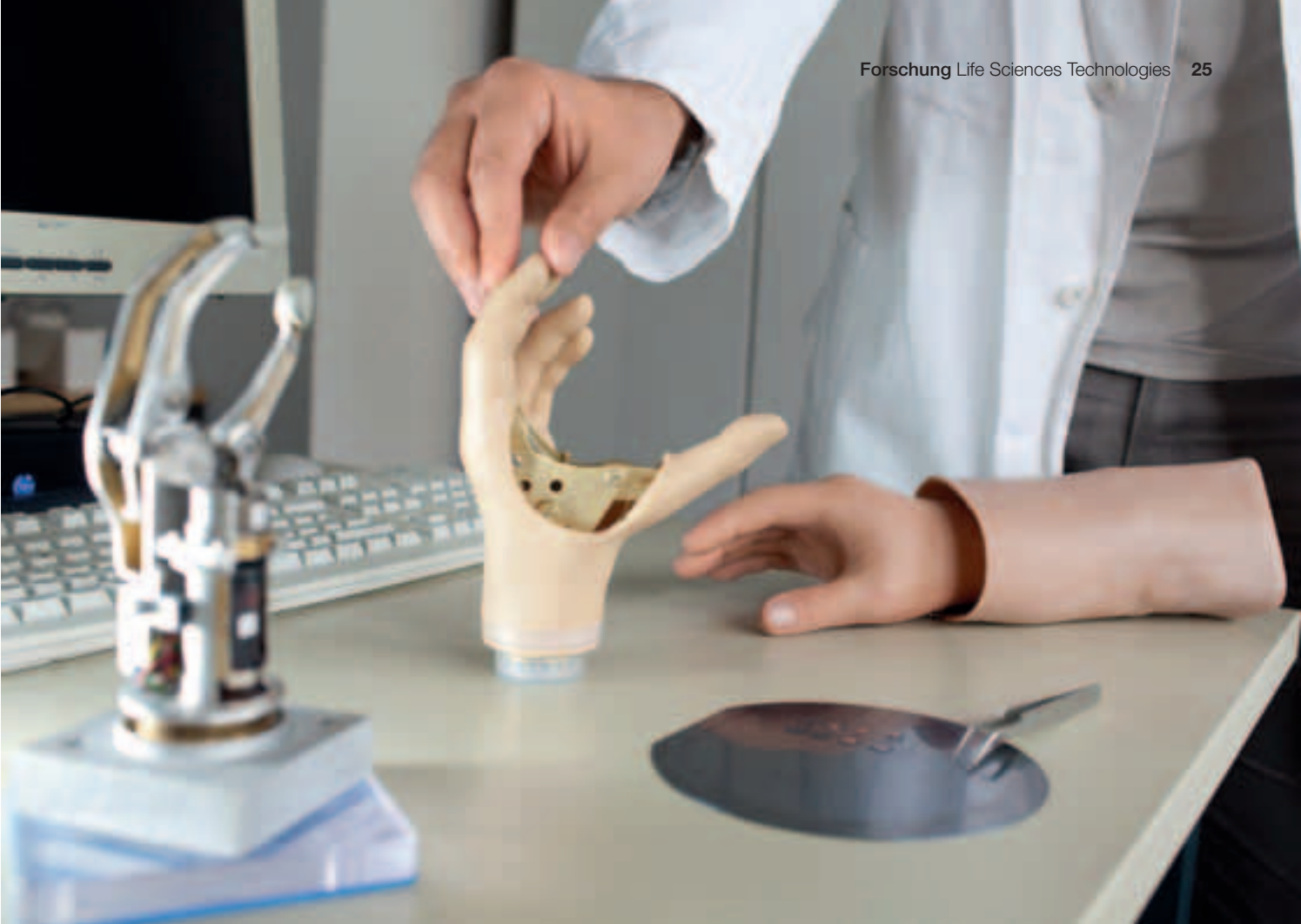
Technik für den Menschen: Zu der myoelektronischen Handprothese gehören ein mechanisches Teil (links) sowie eine Hülle aus Kunststoff (rechts) und ein Mikrochip, im Bild auf der „waver“ genannten Silicium-Scheibe.
