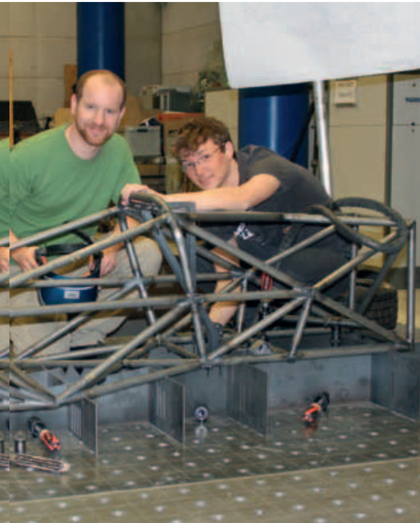
Thomas Busch (links), Master-Student Informatik-Ingenieurwesen, und Max Stehn, Bachelor-Student Maschinenbau, beim Anschweißen der Laschen an den Stahlrohren des egnI4-Chassis.
