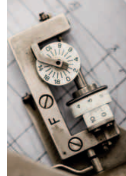
Der so genannte Integrator berechnet die Fläche der gezeichneten Linien und gibt den Studierenden Auskunft zum Beispiel über Volumen, Antrieb und Schwerpunkt des Schiffes.
