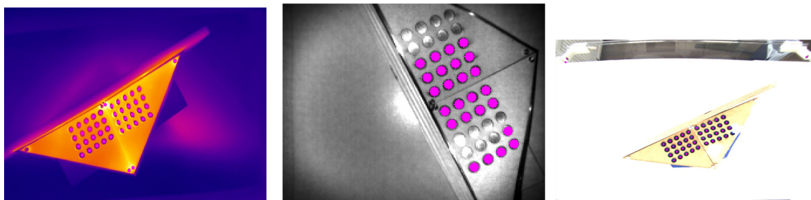
Abb. 5.14: Blob detection im Thermo (li.), ToF (mi.) und RGB-Kamerabild (re.) Bei dem RGB-Bild wurde zur Erhöhung des Kontrastes ein blaues Papier unter das Kreismuster gelegt.
