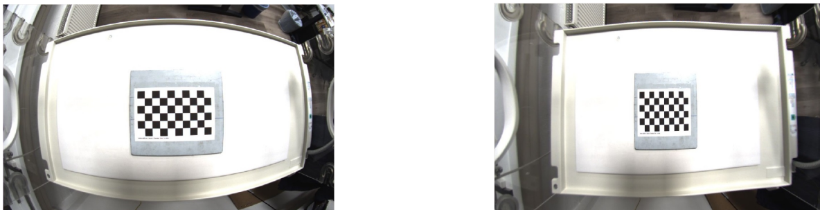
Abb. 5.10: Intrinsische Kalibrierung mit dem zugeschnittenen RGB-Kamerabild unter der Verwendung von 196 Bildern (rechts). Das Kalibriermuster ist ein 5 x 9 Schachbrettmuster mit Quadraten der Seitenlänge 14 mm. Unkalibriertes Bild (links) [Gle+23].
