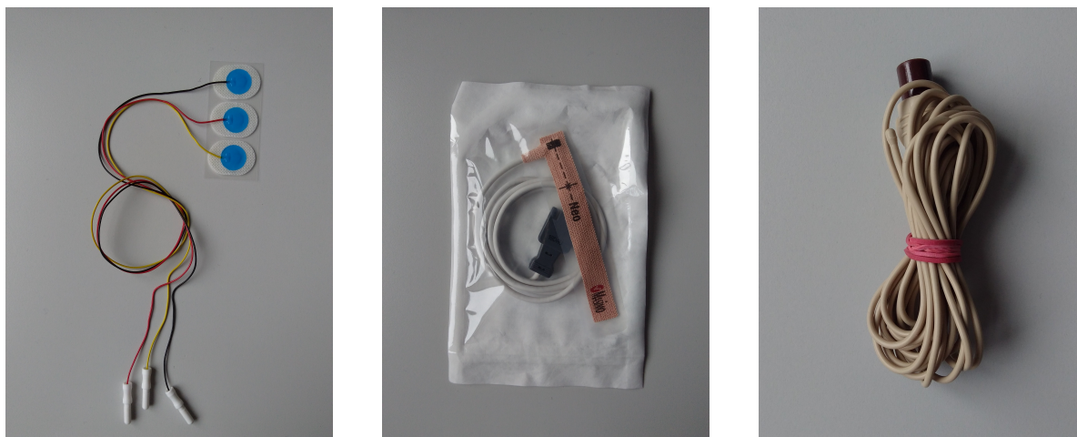
Abb. 5.8: Sensoren für die Referenzmessungen: EKG-Klebeelektroden (re.), Pulsoxymeter (mi.) und rektale Temperatursonde (li.)
