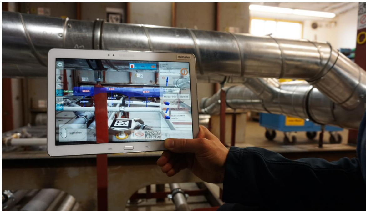
Abbildung 14: Digitales Assistenzsystem zur Visualisierung von Montageinformationen in der schiffbaulichen Unikatproduktion [Frie16, S. 145]
