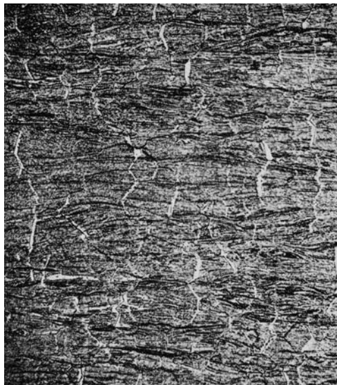
Abbildung 7: Längsschnitt einer Probe nach Nabarro-Herring-Kriechen [SQU01]
