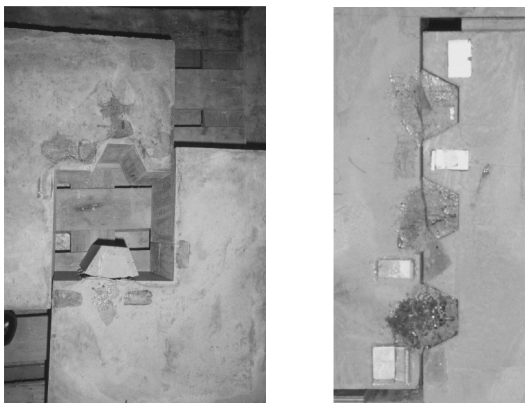
Abb. 5.17: Bruchbilder der Versuchskörper mit einer und mit drei Schubnocken (Ausschnitt)
