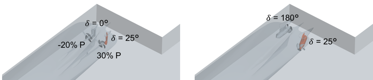
Abbildung 80: Betriebsbedingungen für beide Antriebssysteme.
