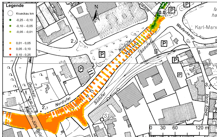
Abbildung 99: Simulierte Sohländerungen (in m) im Unterlauf der Krückau bei km 0,0 (Hafen Elmshorn) bei mittleren Tide- und Abflussverhältnissen (Simulationszeitraum 25.06.2014 – 10.07.2014)
