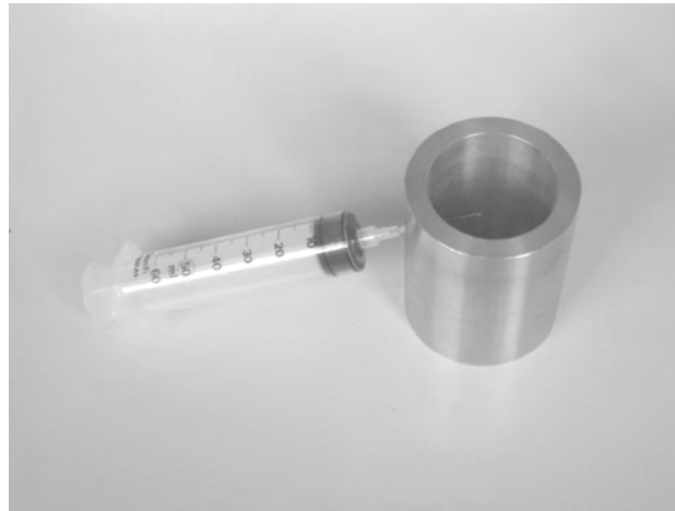
Abbildung 6.27: Vorrichtung zur Volumenbestimmung
