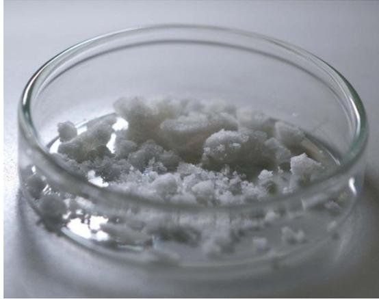
Abbildung 5–13: Kristalle des Endprodukts (2S,5S)-Hexandiol, produziert in der automatisierten Anlage mit nachgeschalteter Adsorption mittels Aluminiumoxid und Umkristallisation bei  $-20\text{ }^{\circ}\text{C}$  in Isoheptan.
