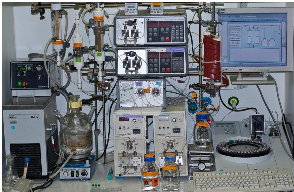
Abbildung 5–16: Gesamtprozess, aufgebaute Anlage mit Steuerung, Wasserbad, Substratbehälter, Autosampler, Pumpen, Magnetventilschaltung (Mitte) und Reaktoren.
