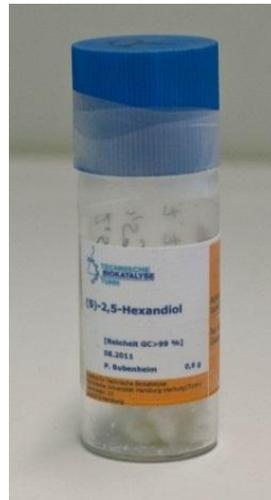
Abbildung 5–14: Kristalle des Endprodukts (2S,5S)-Hexandiol, produziert in der automatisierten Anlage mit nachgeschalteter Adsorption mittels Aluminiumoxid.
