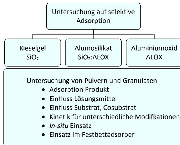
Abbildung 4–1: Schema zur Untersuchung der Adsorption auf anorganischen Adsorbenten
