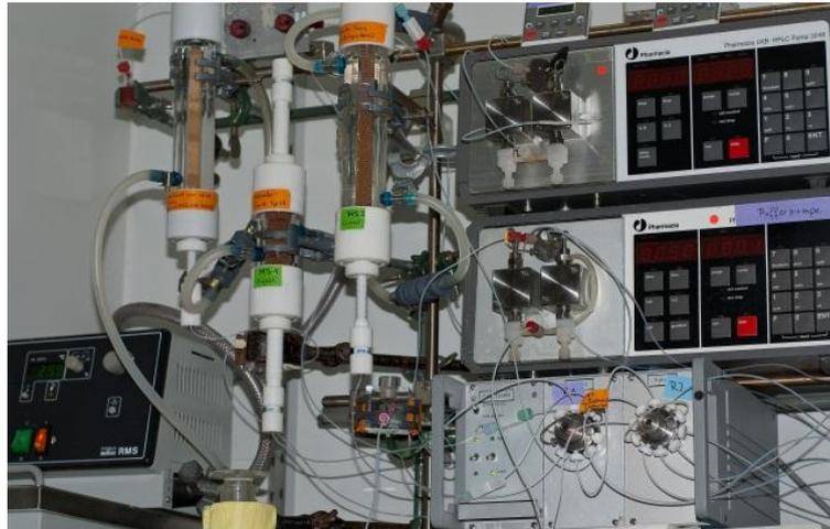
Abbildung 5–15: Ausschnitt aus der Gesamtanlage, Reaktorsäule (links) und zwei Säulen mit Molekularsieb zur Abtrennung von Wasser. Zwei Pharmacia-Pumpen und die Schaltzentrale mit den Magnetventilen.
