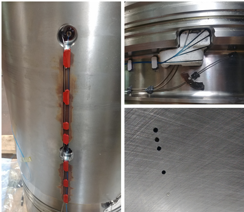
Abbildung 4.8: Leitungsverlegung an der Laufbuchse (links und oben); Messstellenbohrungen von innen (rechts unten)
