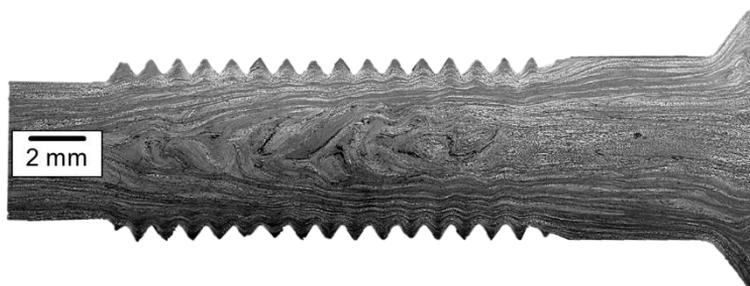
Abbildung 2.14: Schliffbild eines CF-PEEK Bolzens, Axiale-Fasern erscheinen weiss, Faserquerschnitte (helixartige Fasern) erscheinen dunkel
