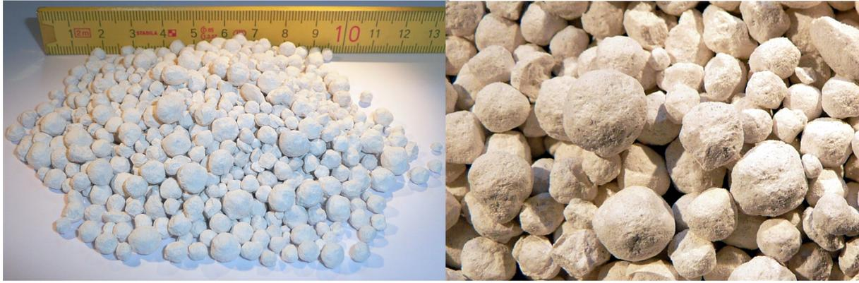
Abbildung 1: Sphärisches Kalkhydratgranulat mit Durchmessern zwischen 2 und 8 mm.
