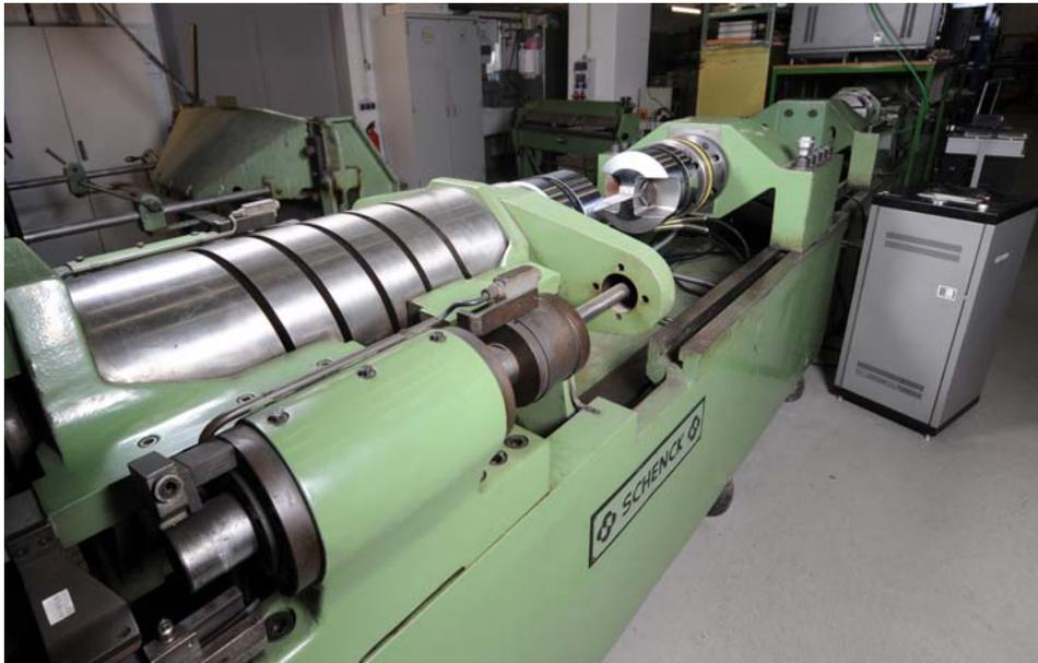
Abb. 6: Horizontal-Resonanzpulsler
