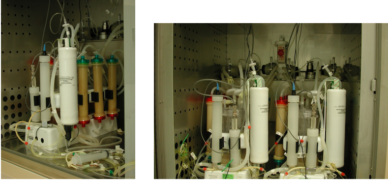
Abb. 1.2: Einwegeinsatz des konventionellen HFBR; links: einzelner Einsatz mit sechs Kartuschen, DO- und pH- Elektrode (vorn links) sowie Gastauscher (vorn rechts); rechts: volle Ausnutzung des Systems mit zwei Einsätzen zu je sechs Kartuschen. (Quelle: ProBioGen AG)
