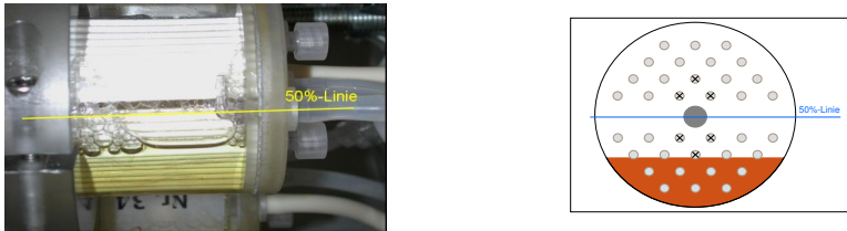
Abb. 5.2: Modul mit starker Schaumbildung (links), Schaum wird ständig durch zentralen Ausgangsport ausgetragen, dadurch sinkt der Mediumspegel deutlich unter 50 % Füllhöhe und mittig platzierte Fasern (rechts, mit Kreuz markiert) tauchen nicht mehr in Medium ein.
