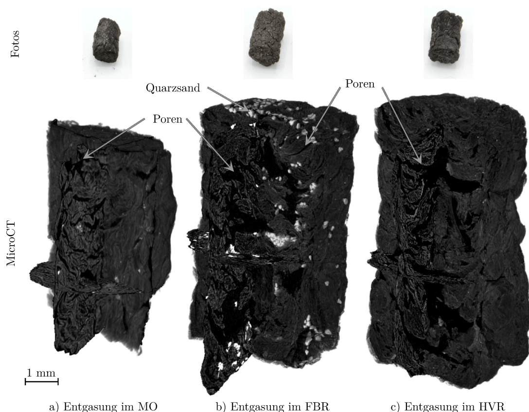
Abb. 4.3: Fotos aus Abb. 4.1 der entgasten Typ A Pellets zusammen mit den dazugehörigen Graustufen-3D-Bildern der mittels microCT gemessenen linearen Absorptionskoeffizienten. Im Vordergrund sind für die microCT-Aufnahmen Schnittbilder gezeigt. Im Hintergrund ist eine volumetrische Darstellung der Voxelwerte zu sehen. (CC BY 4.0, Jarolin, S. Wang et al. (2021a), geändert)
