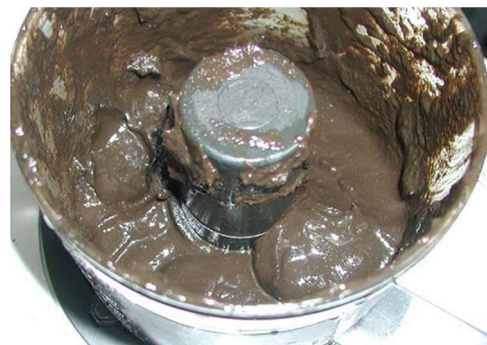
Abbildung 4.2: Rasenschnittsuspension nach einer Nasszerkleinerung mittels Messermühle
