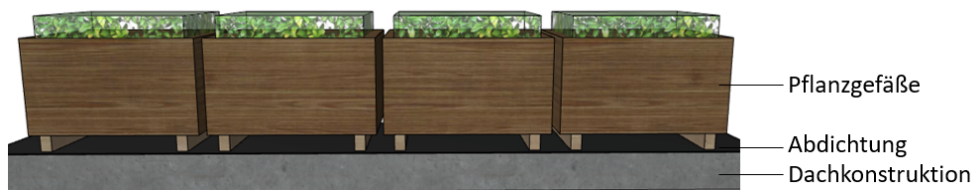
Abbildung 3.7: Schematischer Aufbau von Intensivbegrünungen mit Pflanzgefäßen (Eigene Darstellung in Anlehnung an Pfoser et al. 2013: 68)
