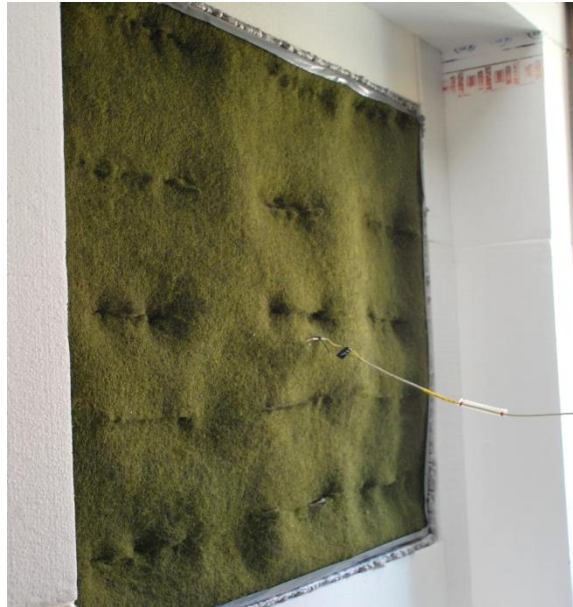
Abbildung 6: Vertiko Element in der Hotbox mit angedrückten Pflanztaschen ohne Substrat (e. A., ZAE Bayern - Würzburg, 09.05.2018)
