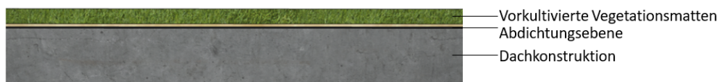
Abbildung 3.2: Schematischer Aufbau von Extensivbegrünungen in Textilbauweise (Eigene Darstellung in Anlehnung an Pfoser et al. 2013: 64)
