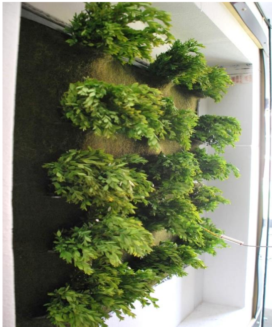
Abbildung 5: Vertiko Element in der Hotbox mit Schlitzten, feuchtem Substrat und echte Buchssträußchen (e. A., ZAE Bayern - Würzburg, 03.05.2018)
