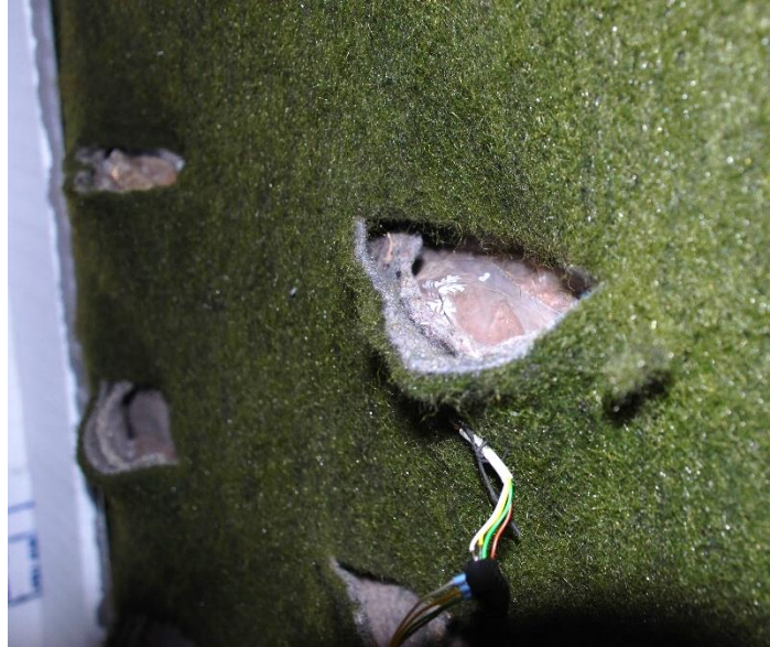
Abbildung 3: Vertiko Element in der Hotbox mit trockenem Substrat in Pflanztaschen sowie dem Temperatursensor (e. A., ZAE Bayern - Würzburg, 23.04.2018)
