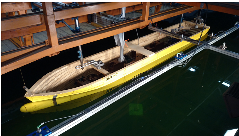
Abbildung 2: Befestigung des Modellschiffs am Schleppwagen
