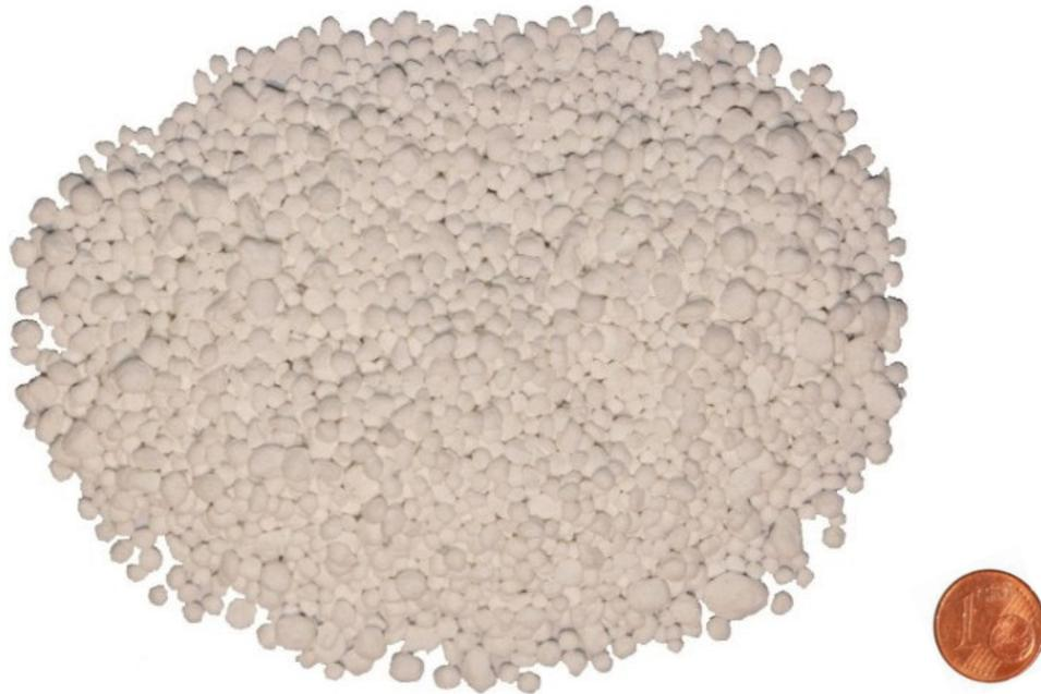
Abbildung 3.4.: Füllstoff OMEGA-BUBBLES C-XL und eine 1 Cent Münze zum Größenvergleich
