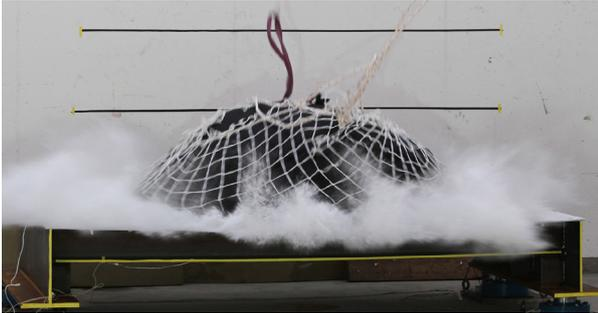
Bild 8: Dynamischer Belastungsversuch eines Schiffsfensters mit einem Wassersack
