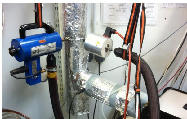
Bild 2: Versuchsaufbau mit HT-PEM (rechts unten) und Sensoren im Abgaskanal
