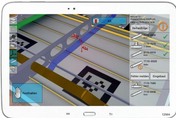
Bild 5: Augmented-Reality-Prototyp zur Darstellung von Montageanweisungen auf einem Tablet Computer
