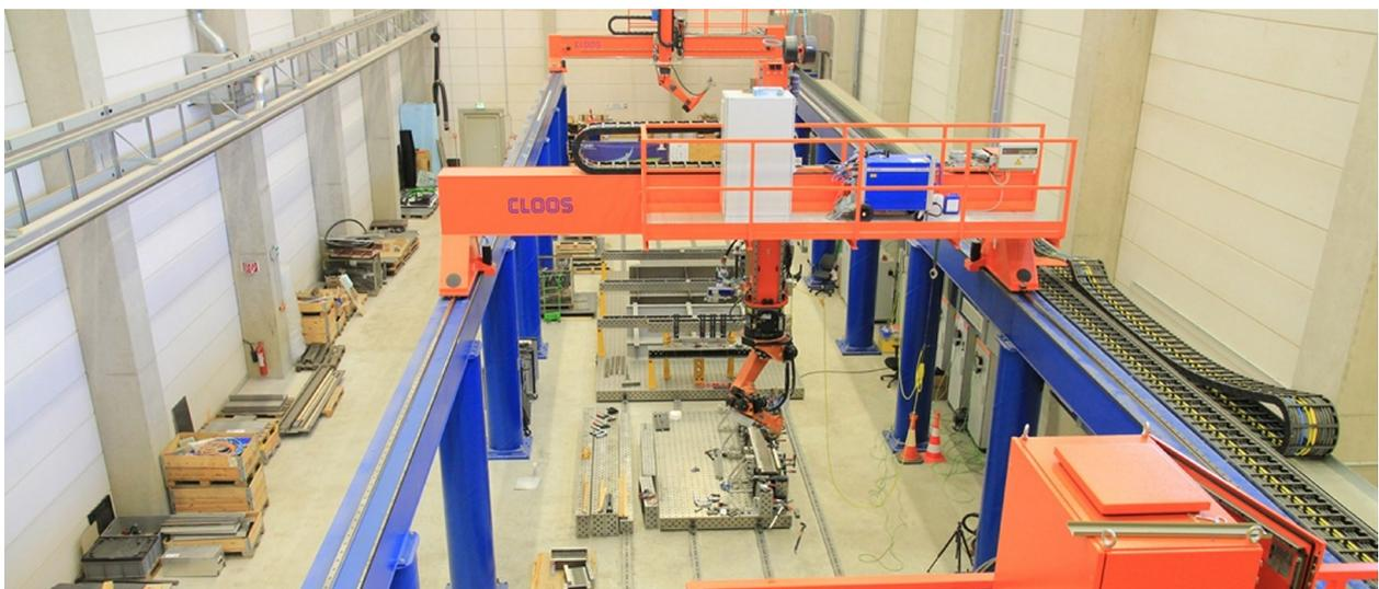
Bild 9: Blick auf den 3D-Laser-Fertigungs-Demonstrator – Portal 1: Laser-Remote-Schweißsystem (vorn), Portal 2: Laser-MSG-Hybridschweißsystem (Mitte), Portal 3: Naht- und Ultraschalldiagnostik (hinten) (Quelle: iLAS)
