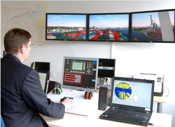
Bild 4: Schiffsführungssimulator (TUHH/MLS)
