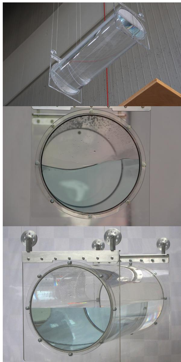
Bild 7: Halb gefüllter Tankcontainer am Versuchstand des Instituts für Mechanik und Meerestechnik
