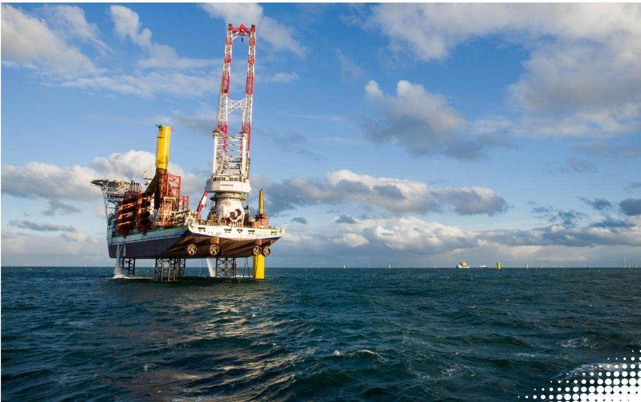
Bild 4: Vorbereitungen zur Durchführung von Feldmessungen bei der Rammung eines Stahlpfahls für eine Tripod-Gründung einer Windenergieanlage im Nordsee-Windpark Global Tech I (Fotoaufnahme des Errichterschiffs „Innovation“)
