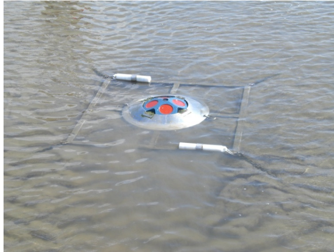
Abbildung 35: Installation der ADCP-Geräte und Drucksonden
