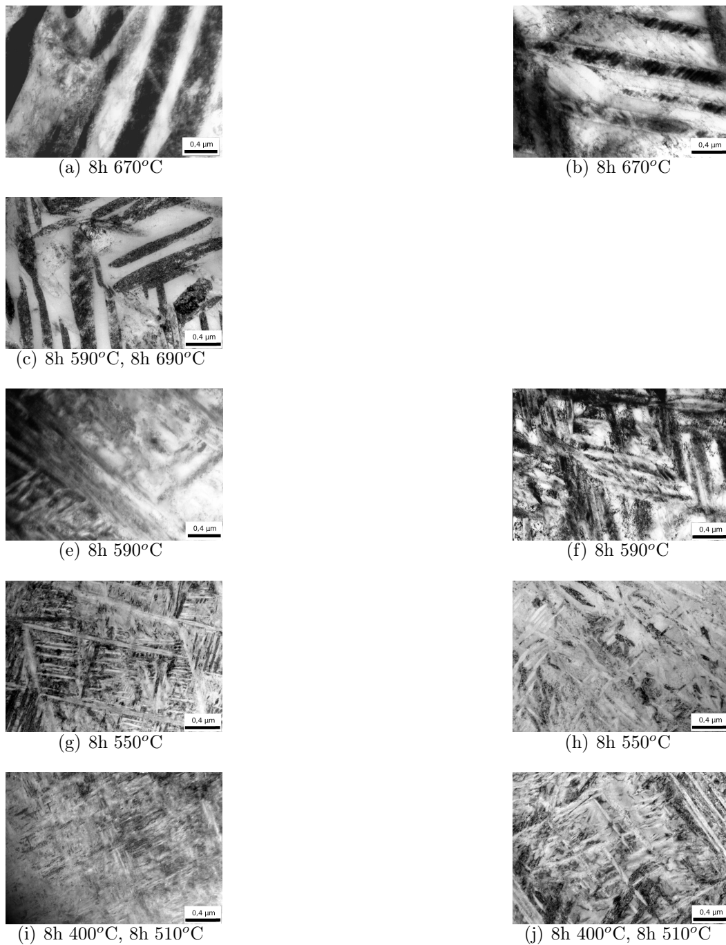
Abbildung 4.5: TEM-Bilder der Proben aus dem Ladishmaterial bei 28k-facher Vergrößerung; links: nicht verformt, 1h 890°C; rechts: verformt, 1h 830°C
