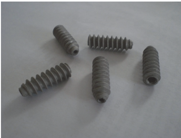
Abbildung 1: Resorbierbares Metallimplantat aus einer Magnesiumlegierung. Prototyp einer etwa 3 cm langen Kreuzbandschraube.
