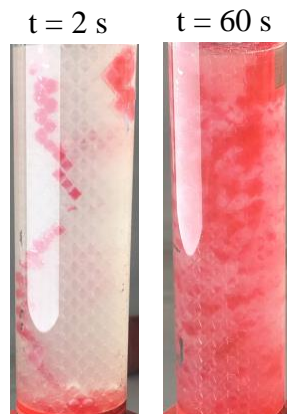
Abbildung 4.8: Gefärbtes Heptan in dichter Phasenverteilerstruktur (POCS, Einheitszelle: Stern tetraeder auf Spitze, Zellgröße 5 mm, Stegbreite: 0,6 mm) und 0.5 M \text{KP}_i -Puffer (pH 7) ( 32 \text{ mL min}^{-1} ). Kanalbildung und Beladung der Struktur nach 60 s.
