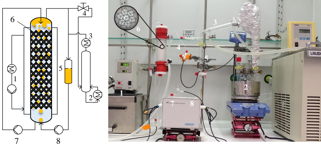
Abbildung 5.4: Hybrider Reaktor zur effizienten 4-VG-Synthese. Fließbild (links) und experimenteller Aufbau (rechts) für die 4-VG-Synthese aus FA (4,8 mM in 0,5 M \text{KP}_i -Puffer pH 7) in einem Flussreaktor mit additiv gefertigter Strömungs- und Enzymträgerstruktur mit direktem Lösungsmittelrecycling. Wässrige Phase: 70,5 mL; organische Phase: 235 mL -1 ; Thermostat (37 °C), 2: Ölbad (140 °C), 3: Wasserkühlung (10 °C), 4: Ventil, 5 Heptanreservoir, 6: Reaktiver Strömungsführer, 7,8: Pumpe (32 mL min -1 )
