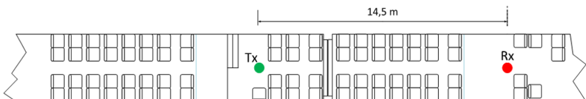
Abbildung 62: Positionierung im Zug von Sender und Empfänger im Szenario „Fahrt durch Mischgebiet im Regionalzug bei 3,6 GHz“
