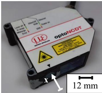
Abbildung 5.7: Sensor S_{e,3} : externer Laser-Distanzsensor zur Aufnahme der Werkstückbewegung d
