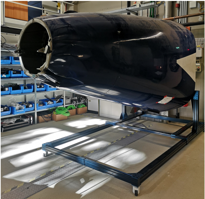
Abbildung 6.14: Versuchsbauteil zur Evaluierung der Projektionsgenauigkeit. Es handelt sich um eine Flugzeughecksektion, die in einer Vorrichtung aus Aluminiumprofilen aufgehängt ist.
