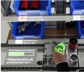
(a) (Video-)Projektionsbasierte Assistenz an einem Einzelarbeitsplatz [301].
