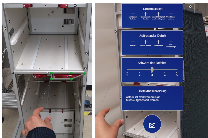
(a) Bedienoberfläche der AR-Applikation nach Markierung eines Defekts an einem Kabinenteil. (b) Bedienoberfläche der AR-Applikation zur Annotation eines Defekts an einem Kabinenteil.
