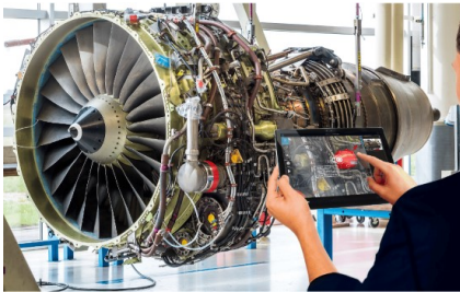
(a) Vollständigkeitsprüfung an einer Flugzeugturbinen basierend auf einer Tablet-Applikation [259].
