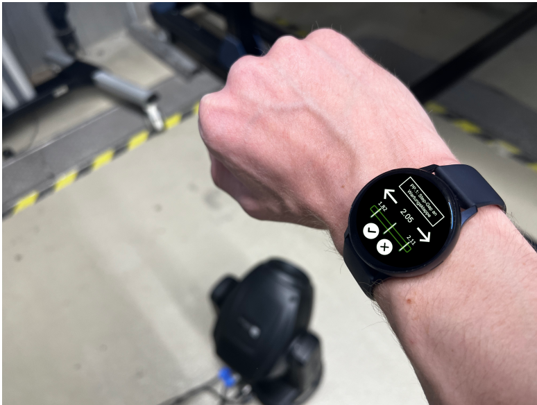
Abbildung A.13: Bedienoberfläche zur Interaktion mit dem Steuerungsmodell mithilfe einer Smartwatch.
